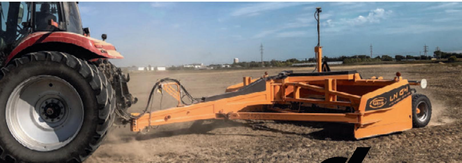
La niveleuse LN G4, adaptée pour l'utilisation sur tracteurs de 100 à 250 HP (75 à 190 KW), comprend toujours les options suivantes par défaut :
