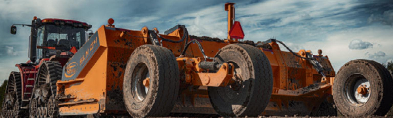
La niveleuse SLN G4, adaptée pour l'utilisation sur tracteurs de 300 HP et + (225 KW et +), comprend toujours les options suivantes par défaut :
