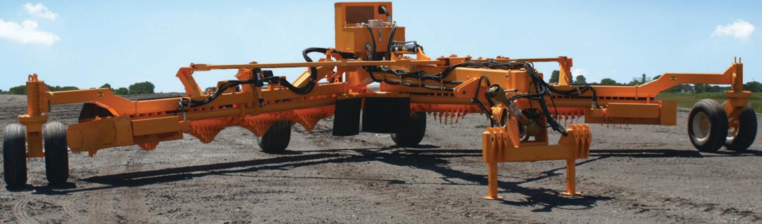
Le DRR-30H est un râtelier à roches double vrille conçu pour les travaux majeurs. Avec deux vrilles flottantes de 14 pi, l'unité se déploie à un angle de 120 degrés pour atteindre une largeur de travail de 27 pieds. L'espace central de 30 po permet la formation d'un andain de roches unique. Entraînement hydraulique actionné par la prise de force du tracteur, protégé par soupape de surpression et refroidi par échangeur thermostatique. Contrôle hydraulique de profondeur.
