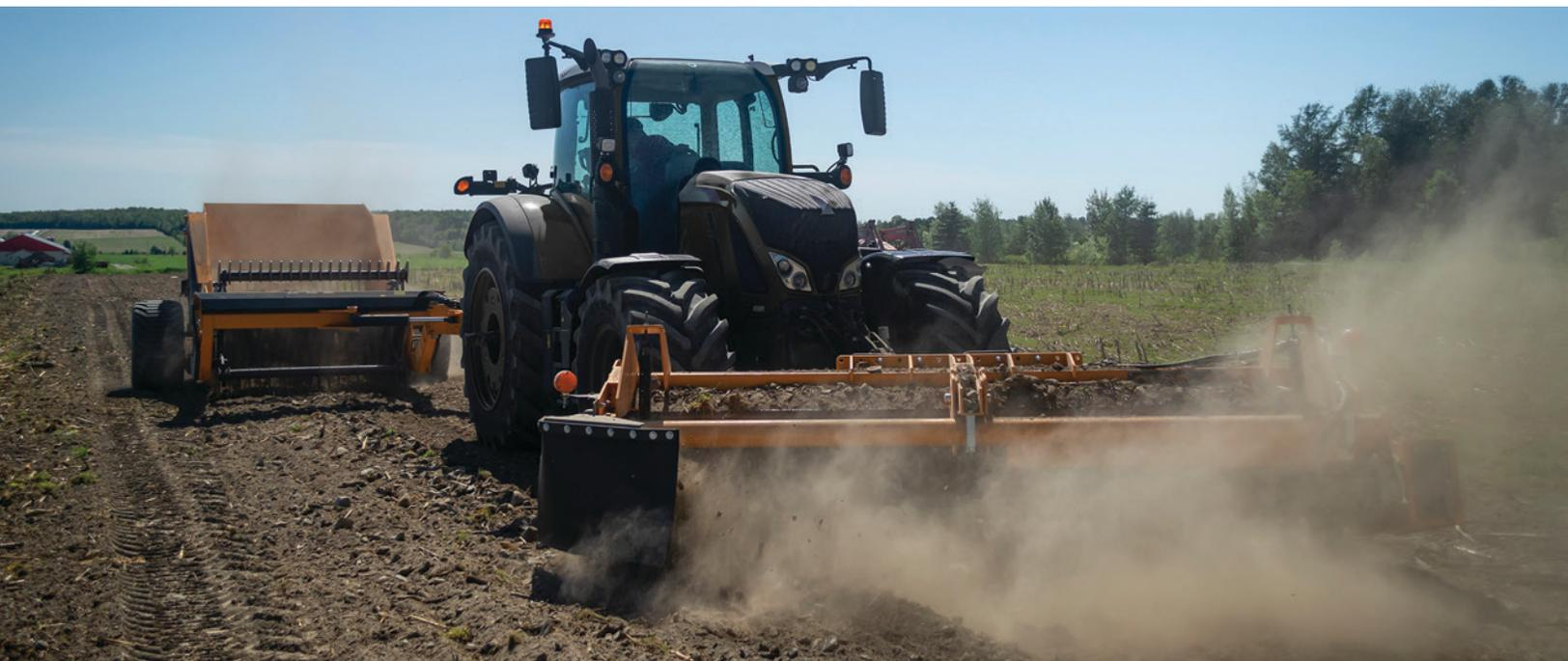
Le râteau à roches **FWD-14** est fait pour mettre en andain les roches rendant ainsi le ramassage de ces dernières beaucoup plus facile. Installé à l'avant sur le 3 points du tracteur crée un combo parfait avec une ramasseuse à roches *Rock Master* (page 21).
