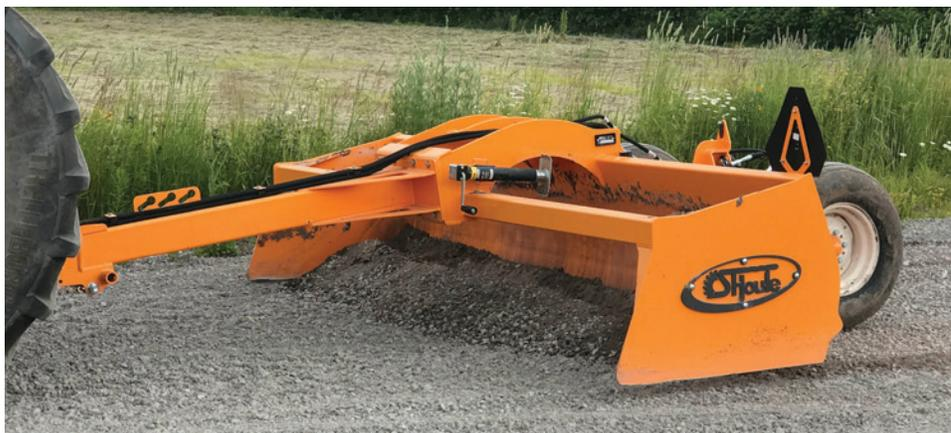
La niveleuse HLL s'utilise avec des tracteurs de 40 à 110 HP (30-82 KW). D'une robustesse imbatale, la niveleuse HLL de type panier peut niveler presque n'importe quel type de surface, des chemins en gravier, aux chemins de terre, aux champs. Les fonctions d'inclinaison et de hauteur sont contrôlées à l'aide de 3 cylindres hydrauliques.
