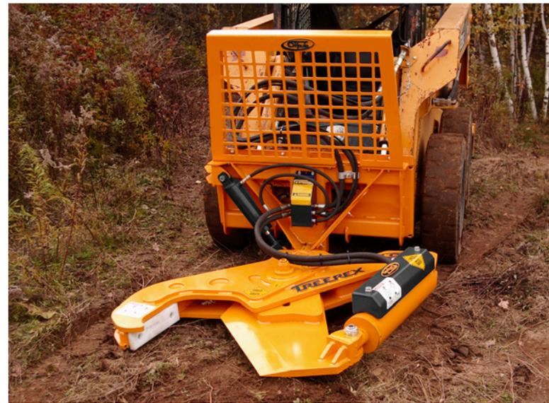
Cisaille hydraulique conçue pour couper des branches ou de arbres de 16" (41 cm) de diamètre. Sa lame unique permet de mieux contrôler la qualité de coupe ainsi que l'orientation de chute, sa mâchoire concave favorise la prise sur la surface à couper. S'adapte aux chargeurs à patins guidés (SSL), chargeurs télescopiques etc.
