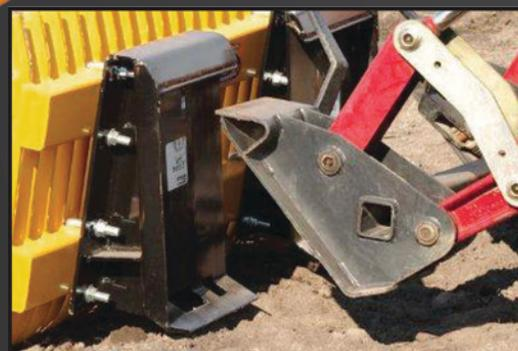
*Les systèmes d'attaches sont conçus pour épouser les angles de travail déterminés par les fabricants d'origine.*
